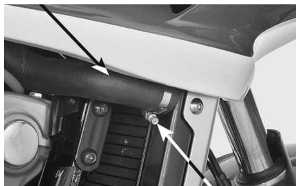
PARAFUSO DA BRAÇADEIRA MANGUEIRA INFERIOR DO RADIADOR
