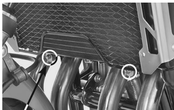
PARAFUSOS MANGUEIRA SUPERIOR DO RADIADOR
