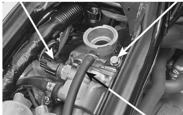
MANGUEIRA-SIFÃO TUBO DE CONEXÃO
