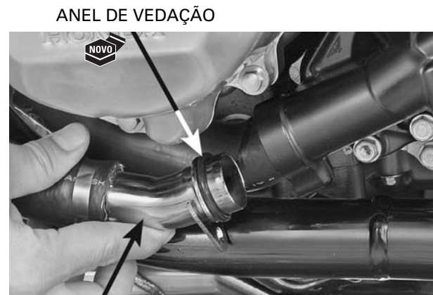
TUBO DE CONEXÃO TUBO DE CONEXÃO DA MANGUEIRA DO RADIADOR
