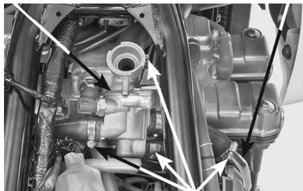
PARAFUSOS DA BRAÇADEIRA MANGUEIRA DE ÁGUA
